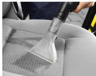
Redukcja wilgoci o 50% możliwa dzięki metodzie spryskiwania i odsysania
